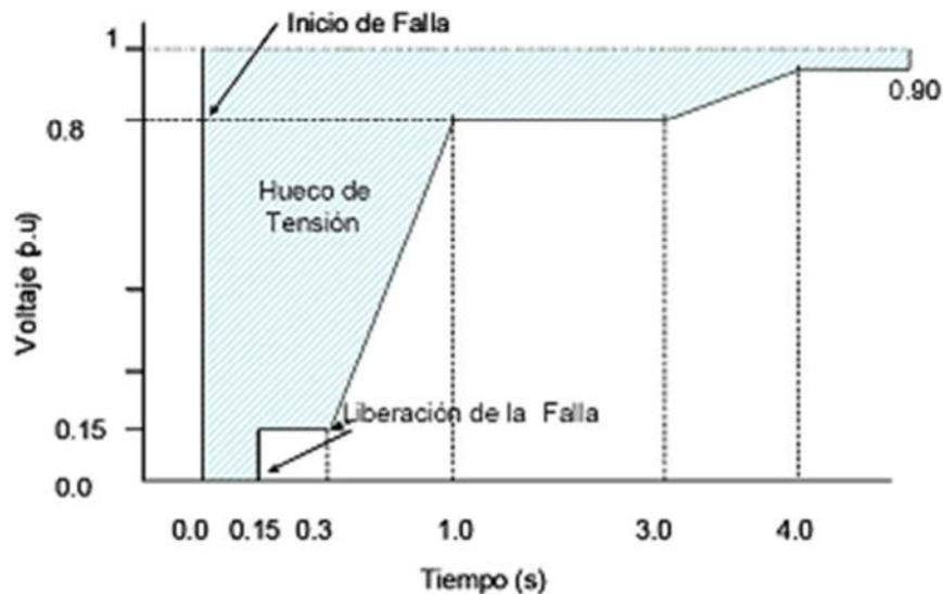
**Figura 2.** Gráfico de caída de tensión por falla.
