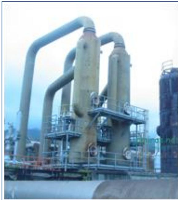
*Fig. 3. Separador centrífugo vertical con faldón y salida superior de vapor.*
