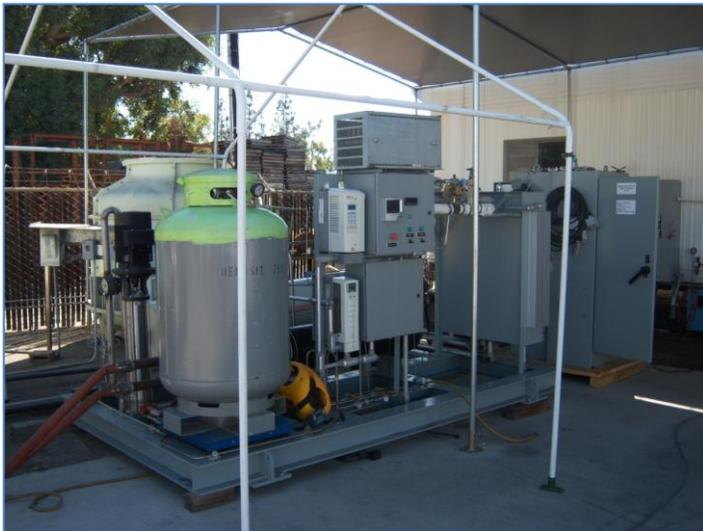
*Fig. 21. Planta de ciclo binario de fase variable de 70 kW de capacidad.*
