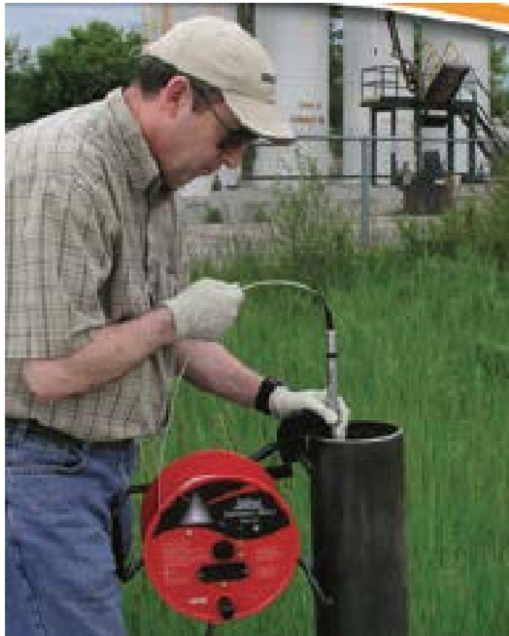
Figura 20: Medición de temperatura en pozo.
